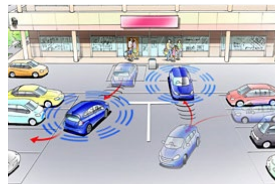
自動バレー駐車システム
