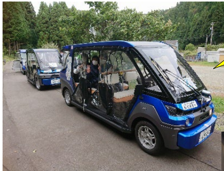
1人の遠隔監視・操作者が3台の無人自動運転車両を運行
