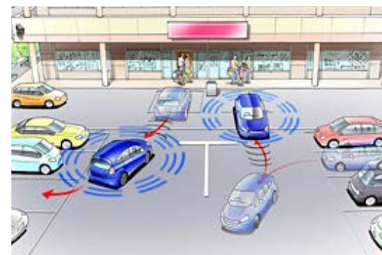
自動バレー駐車システム
