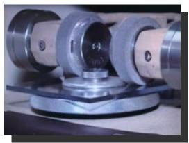
Fig. : Abrasion testing
